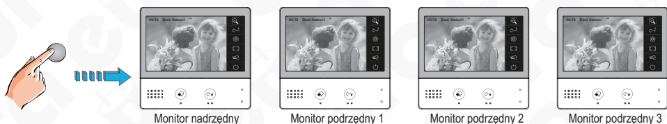
Rys. 17. Funkcja wyświetlania podglądu z kasety zewnętrznej jednocześnie na kilku monitorach
