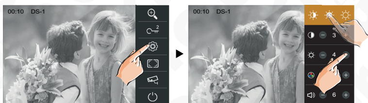
Rys. 12. Zmiana parametrów obrazu i głośności rozmowy
