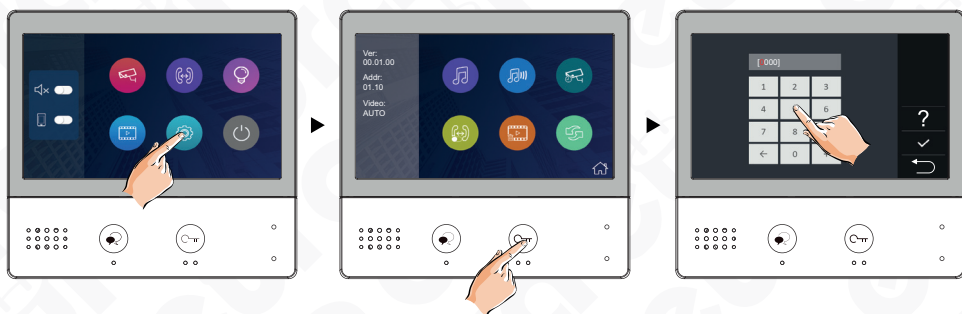
Rys. 14. Wejście w tryb ustawień instalatora
