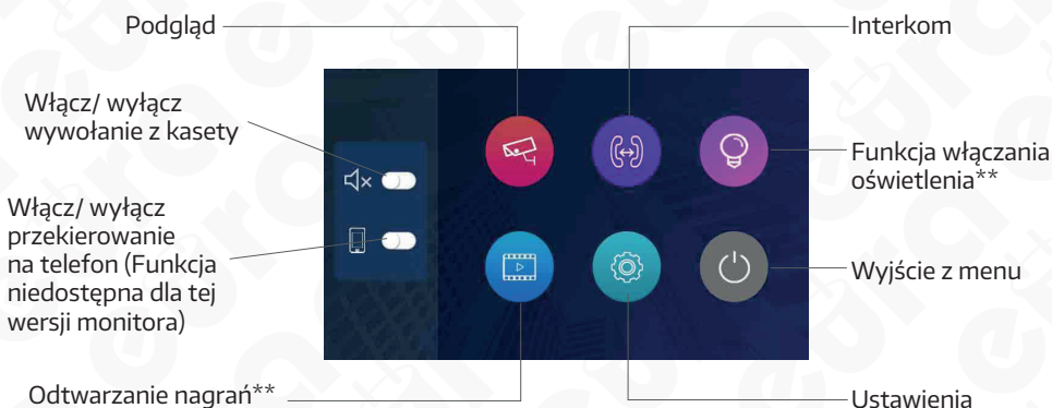
Rys. 6. Wejście do menu głównego
